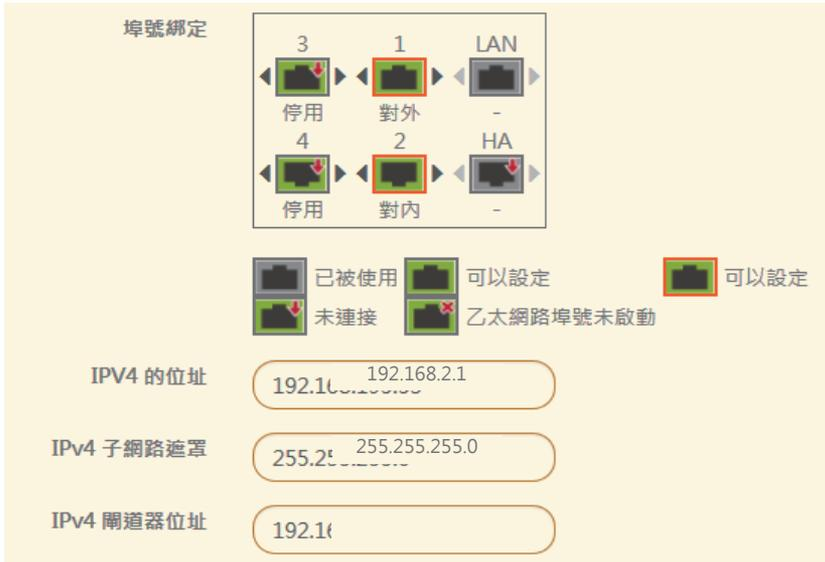
图 2-4 透通模式的 Port 及 IPv4 地址设定
