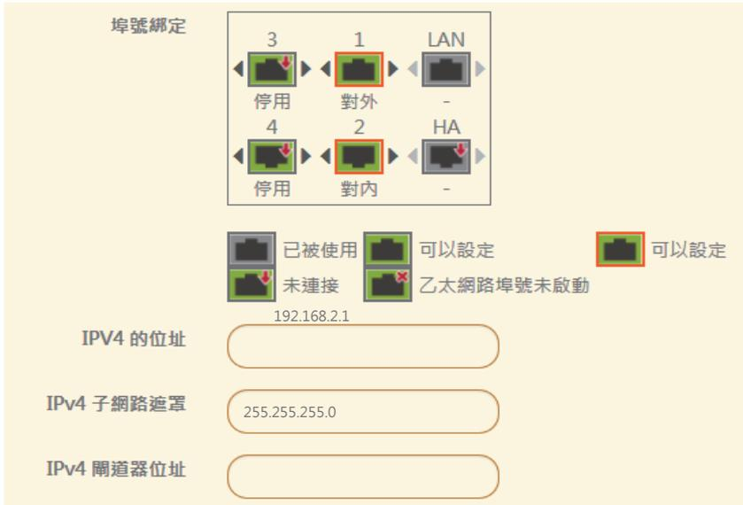
圖2-4 透通模式的 Port 及 IPv4 位址設定
